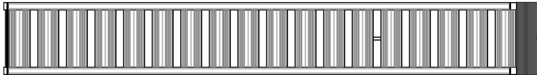
\*Die Tragkraftangaben gelten pro Paar und beziehen sich auf ein zweiachsiges Fahrzeug mit einem Achsabstand von 1500 mm und einer gleichmässigen Lastverteilung (50% zu 50%).
